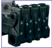
· Bomba de tres pistones · Sellado con sistema de doble circulación y lubricación a baja presión · Válvulas de aspiración con un nuevo diseño de cierre esférico · Lubricación por salpique
