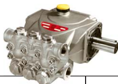
SERIE SS1 CULATA INOX AISI 316L (192X207X107mm | 6Kg | eje Ø24mm | SAE 15W40)
