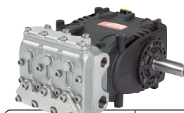
SERIE 70SS CULATA INOX AISI 316L (387x340x196mm | 40Kg | eje Ø30mm | SAE 15W40)
