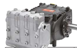
SERIE 70 H.P. CULATA NICKELADA (395x340,5x212mm | 41Kg | eje Ø30mm | SAE 15W40)
